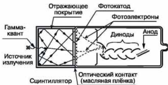
Рис. 3. Схематическое устройство сцинтилляционного детектора.
